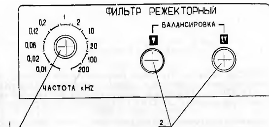
Рис. 6. Внешний вид передней панели фильтра режекторного: 1 — частота «кHz» — переключатель частоты режекции; 2 — «Балансировка» — ручки грубой и плавной балансировки фильтра
