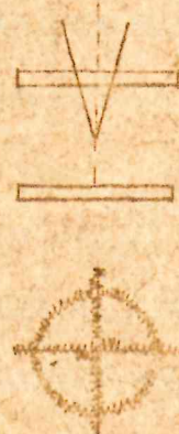
Правильная наводка на резкое изображение марки
