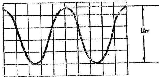
Рис. 3. Измерение полного размаха переменного напряжения
