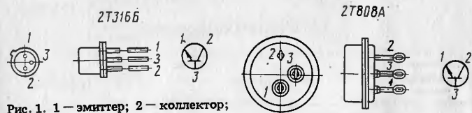
Рис. 2. 1 — эмиттер; 2 — коллектор; 3 — база
