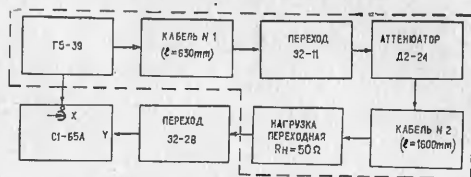
Рис. 7. Схема соединения приборов при определении времени нарастания переходной характеристики
