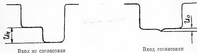
Рис. 25. Осциллограммы напряжений при согласованных и несогласованных нагрузках
