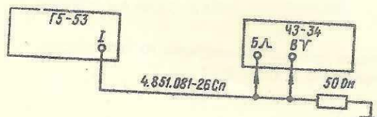
Рис. 20. Схема измерения длительности основных импульсов: I - клемма "Выход"
