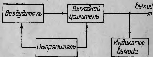
Рис. 1. Схема структурная электрическая генератора ГЗ-36
