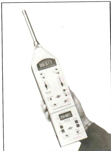
Рис. 1. Интегрирующий прецизионный шумомер 2230 с набором треть-октавных и октавных фильтров 1625
