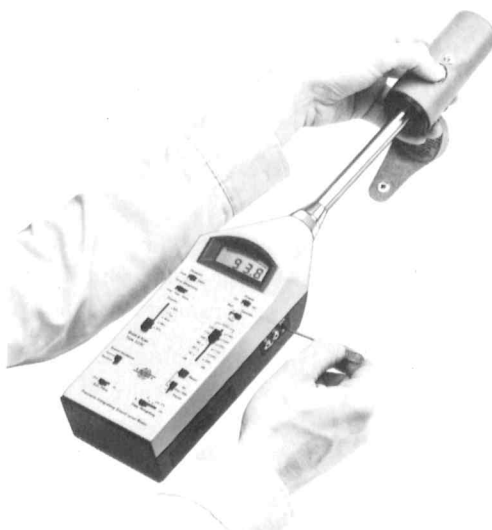
Рис. 3.4. Настройка интегрирующего прецизионного шумомера 2230 при поверке и градуировке, осуществляемой при помощи акустического калибратора 4230
