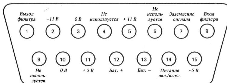
Рис. 2.3. Соединитель с 15 выводами, способствующий соединению набора третьоктавных и октавных фильтров 1625 с интегрирующим прецизионным шумомером 2230 или 2233
