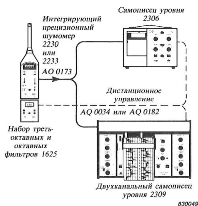
Рис. 3.5. Система, содержащая интегрирующий прецизионный шумомер 2230 или 2233, набор третьоктавных и октавных фильтров 1625 и самописец уровня 2306 или 2309 и способствующая автоматическому частотному анализу и синхронной регистрации спектрограмм
