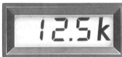
Рис. 2.2. Индикаторное табло с цифровым индикатором средней частоты полосы пропускания набора третьоктавных и октавных фильтров 1625
