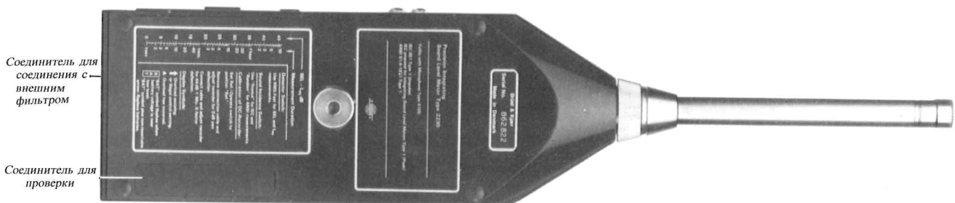
Рис. 2.6. Задняя панель интегрирующего прецизионного шумомера 2230
