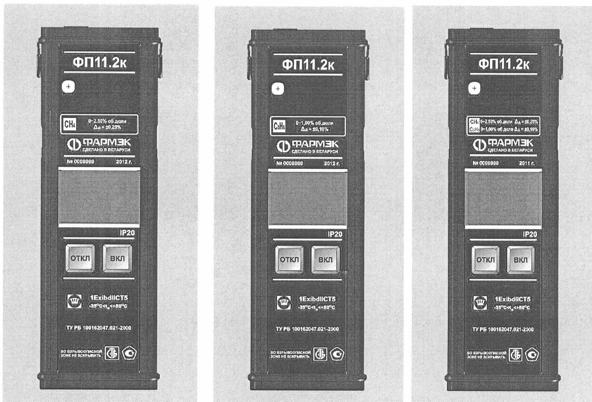
Рисунок 2 - Внешний вид газоанализаторов ФП11.2к с термокаталитическим датчиком
