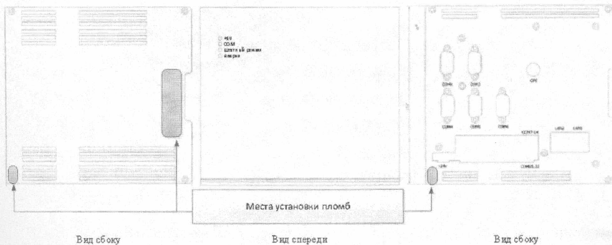
Рисунок 4 – Общий вид и места пломбирования УСПД «ЭКОМ-3000» исполнения Т
