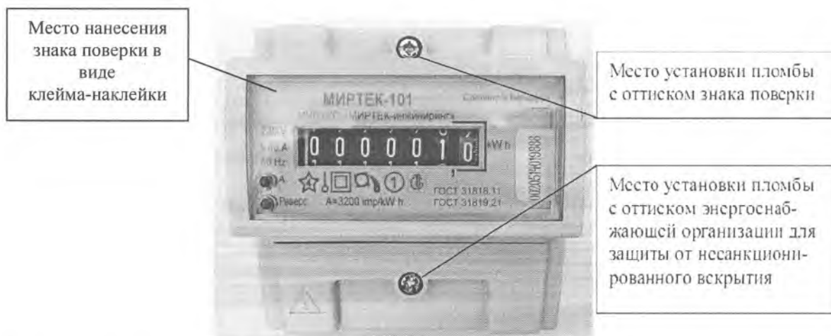
Рисунок А.4 – Места установки пломб и нанесения знака поверки для счетчиков в корпусе модификации D3
