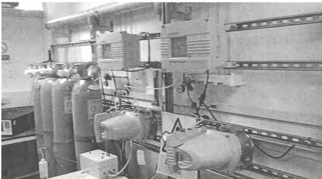
Рисунок 1. Внешний вид газоанализаторов
