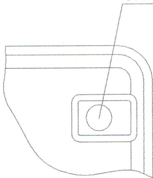
Рисунок 1 – Место пломбирования вольтметра
