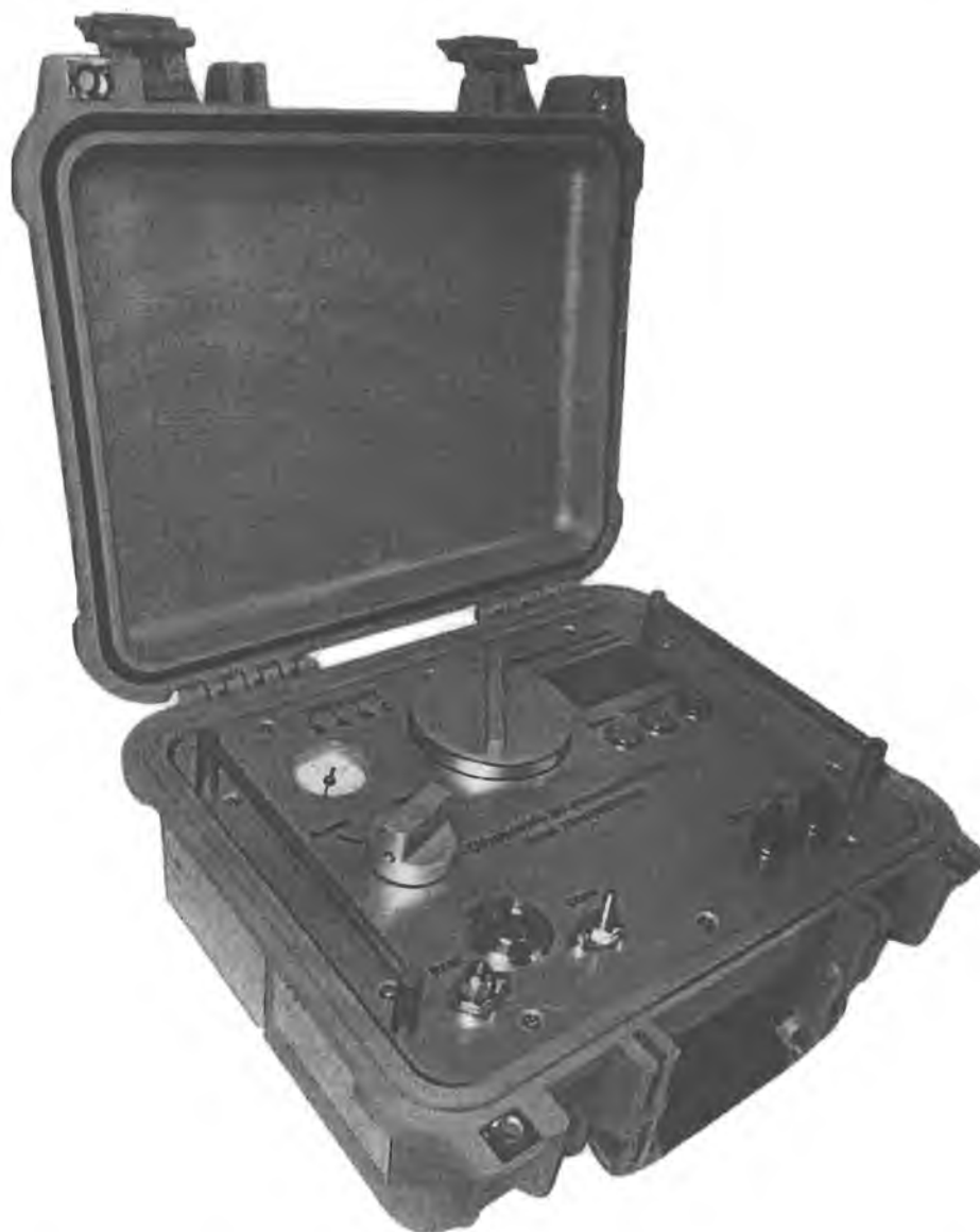
Рисунок 1 – Анализаторы содержания кислорода переносные КС 50.430-000, внешний вид
