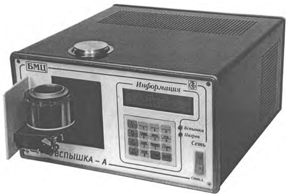
Рис. 1 Внешний вид регистратора автоматического температуры вспышки нефтепродуктов «Вспышка-А»
