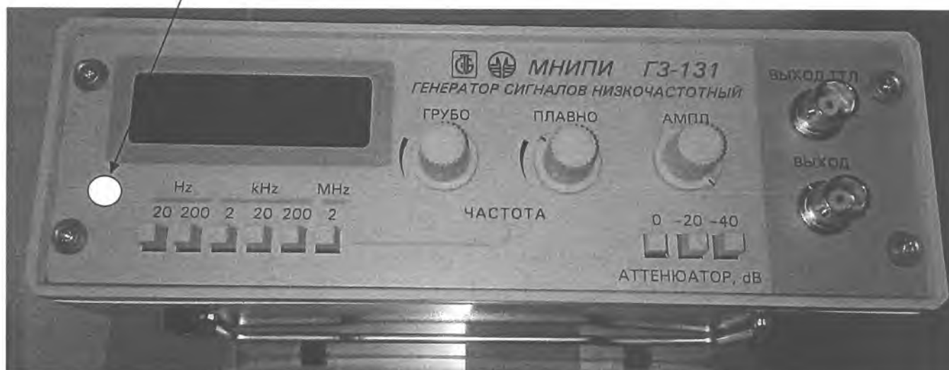
Рисунок А.1 – Передняя панель генератора с указанием места нанесения знака поверки (клейма-наклейки)
