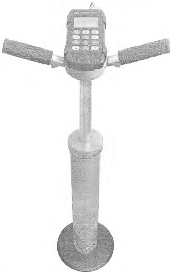
Рисунок 1 – Общий вид измерителя динамического модуля упругости грунтов ДПГ (модификация ДШ-1.1)
