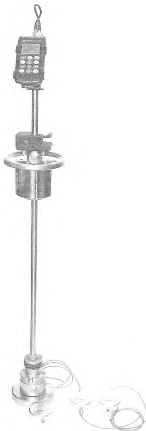
Рисунок 3 – Общий вид измерителя динамического модуля упругости грунтов ДПГ (модификация ДПГ-ДДК)
