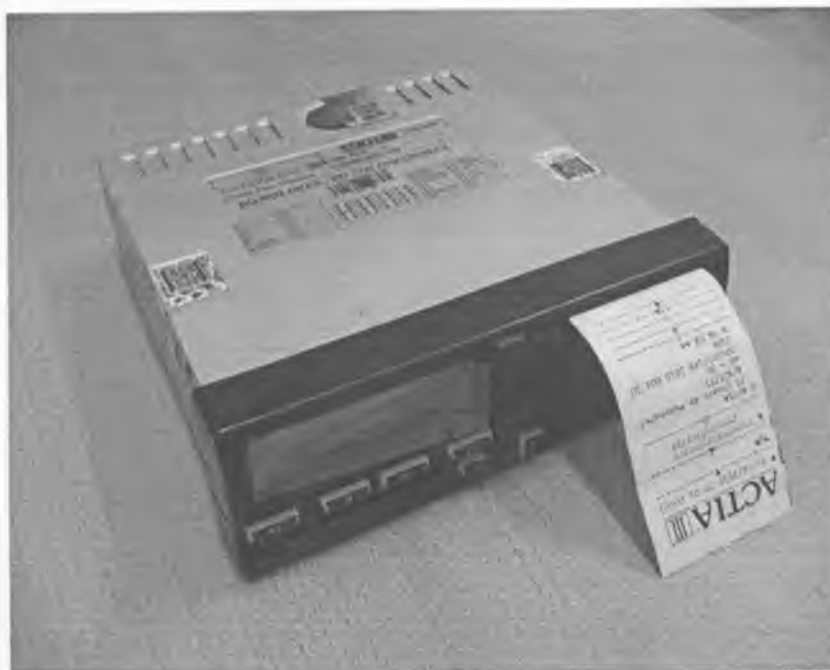
РИС. 1- ВНЕШНИЙ ВИД ТАХОГРАФА ЦИФРОВОГО SMARTACH
