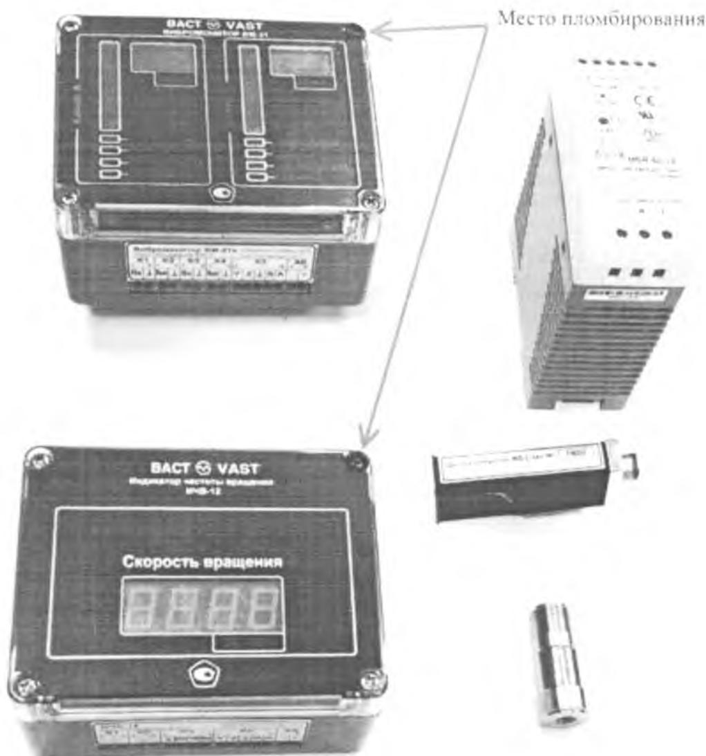
Рисунок 1 - Внешний вид и место пломбирования комплекса KVК-21М
