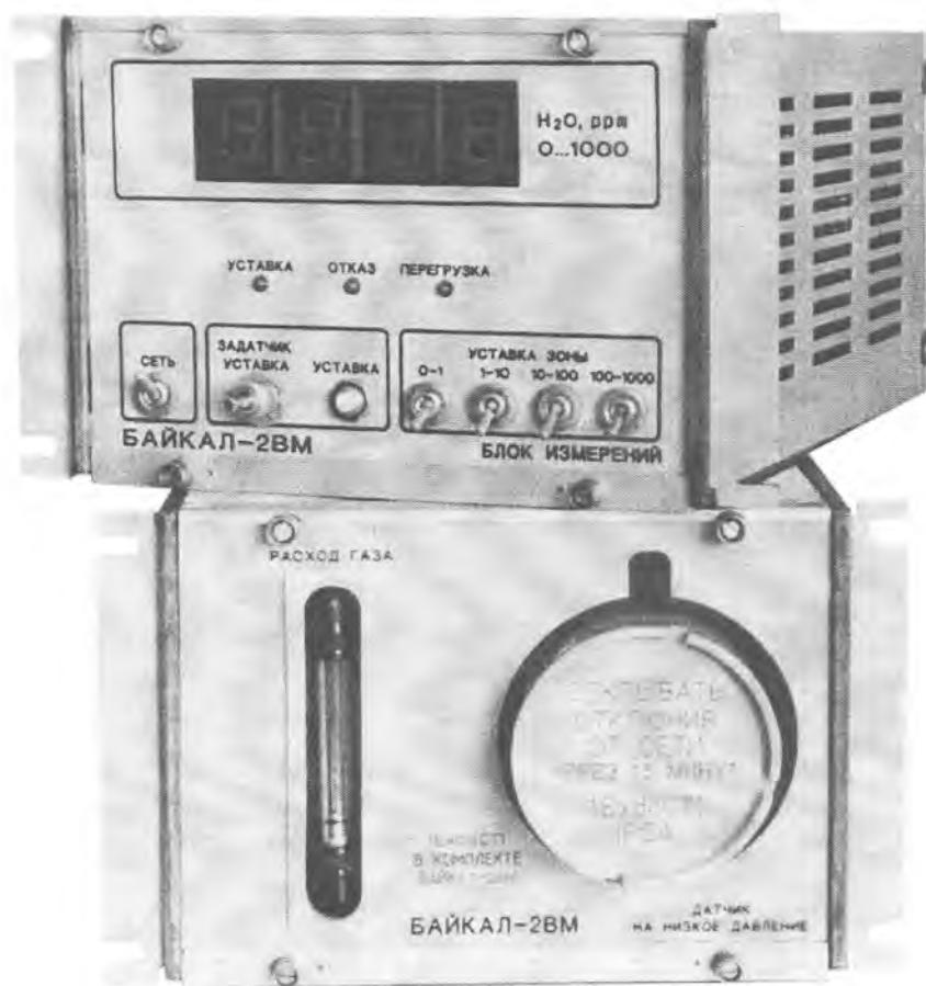
Рисунок – Гигрометр кулонометрический БАЙКАЛ-2ВМ
