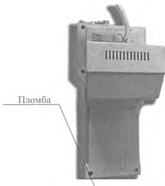
Рисунок 2 – Схема опломбирования преобразователей от несанкционированного доступа
