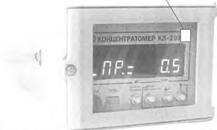
Рисунок А.1 - Схема нанесения на концентратомер знака поверки
