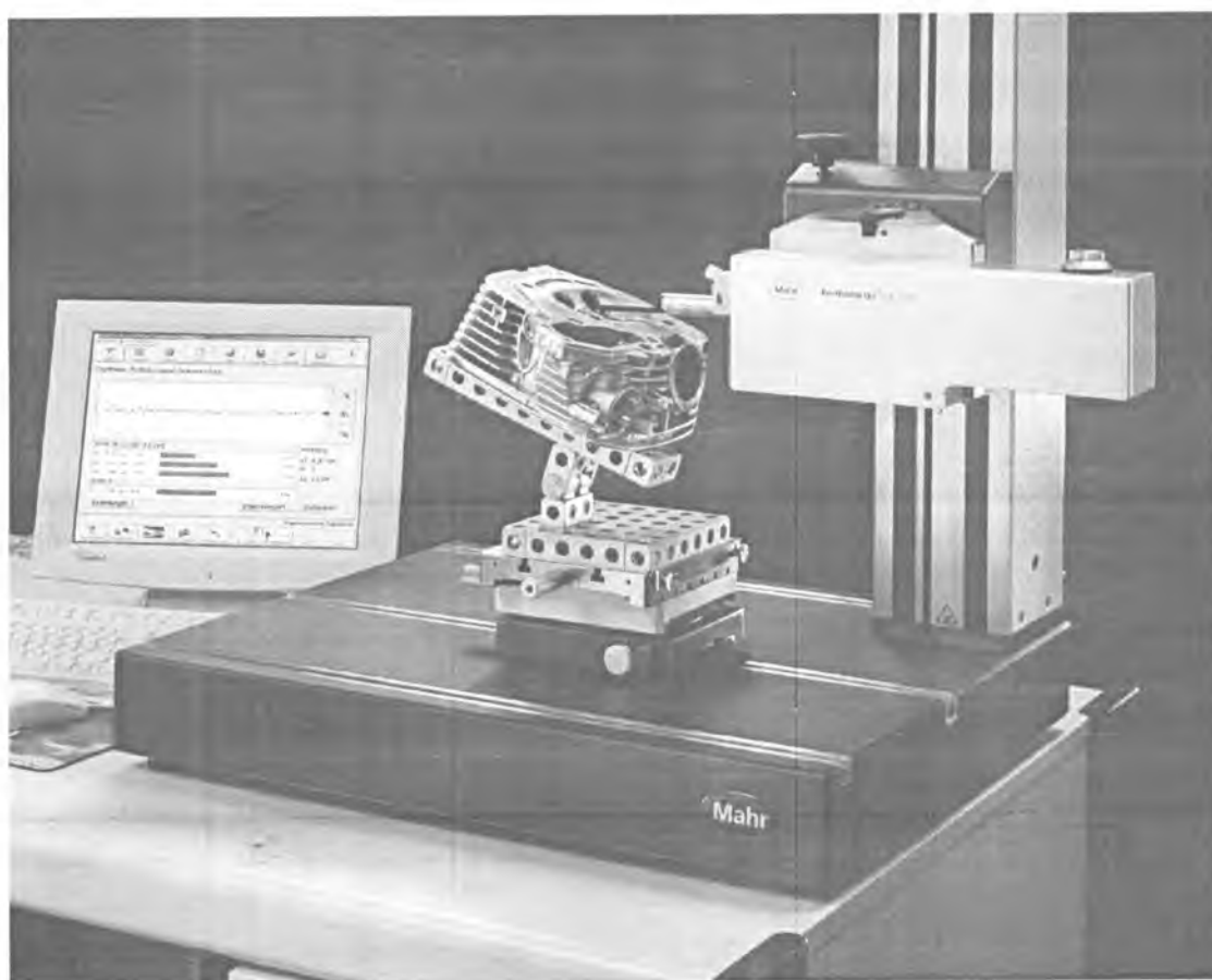
Рисунок 5 – Внешний вид приборов для измерения шероховатости поверхности MarSurf XR20 в составе с GD 120
