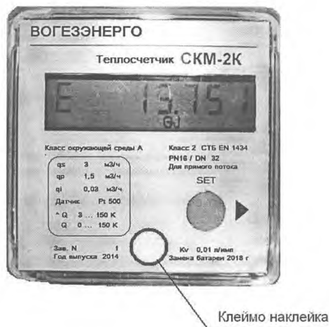
Рис. 2 Схема нанесения знака поверки в виде клейма – наклейки на переднюю панель вычислителя.
