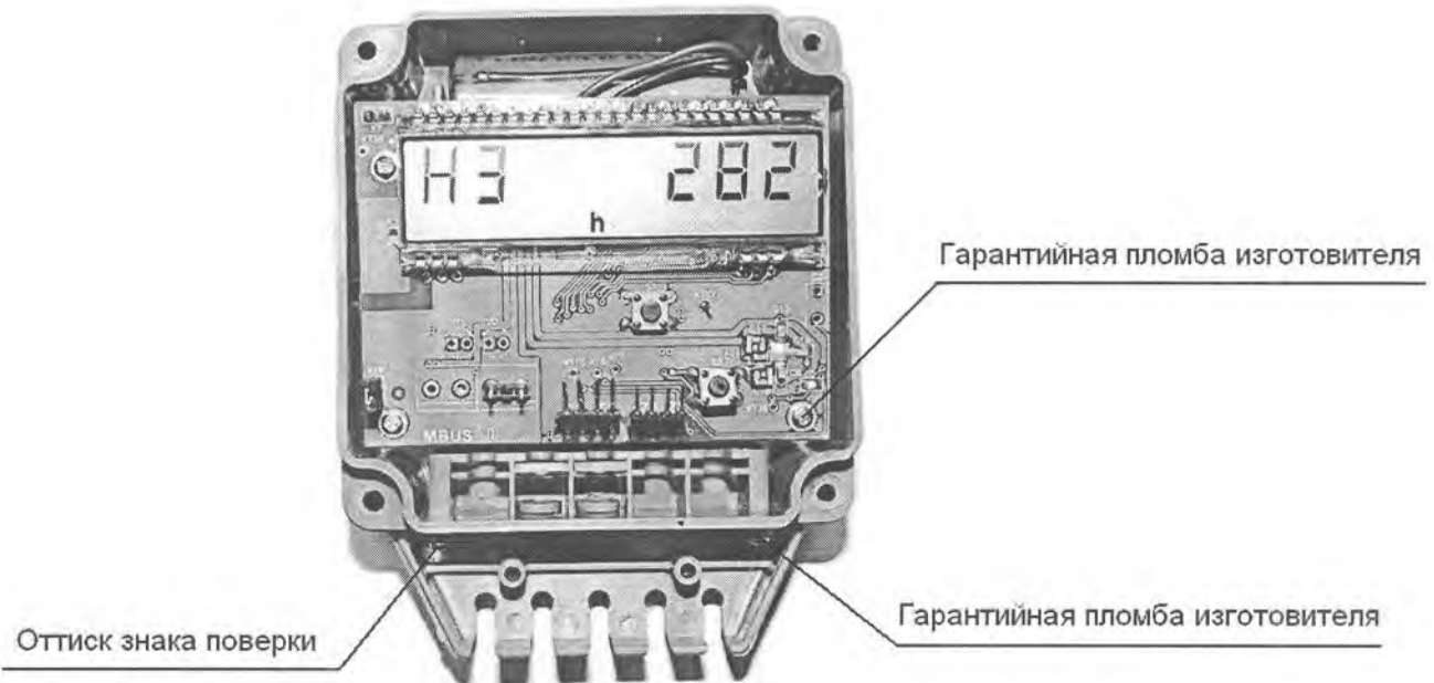
Рис.1 Схема нанесения оттисков знаков поверки и гарантийных пломб изготовителя внутри вычислителя
