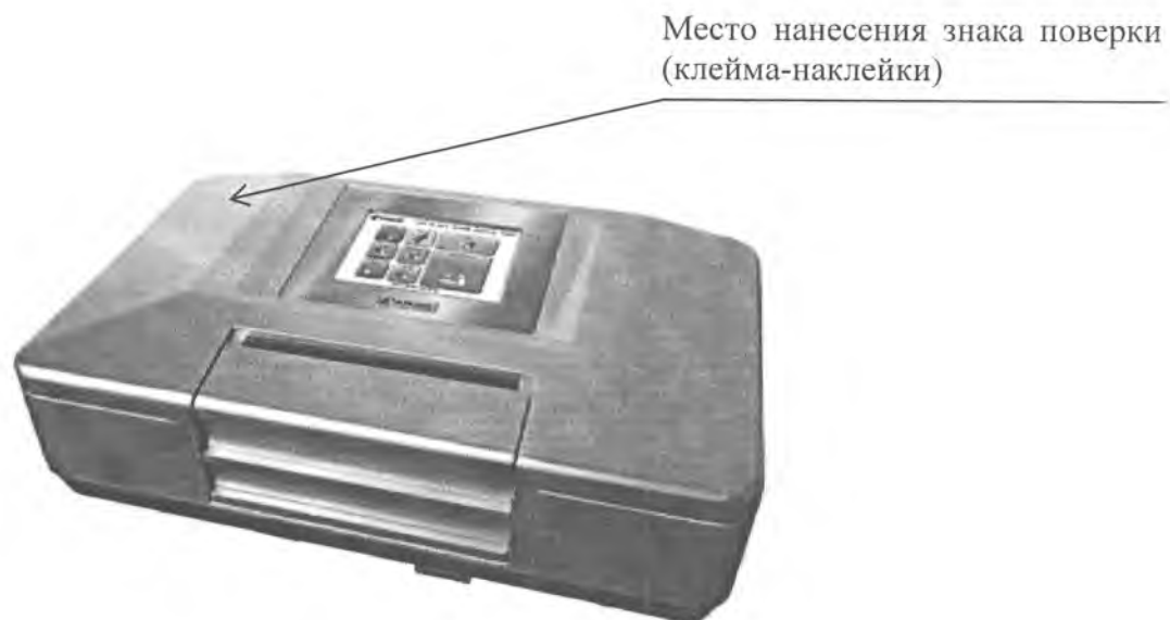
Рисунок 3 - Место нанесения знака поверки на поляриметр автоматический AP-300
