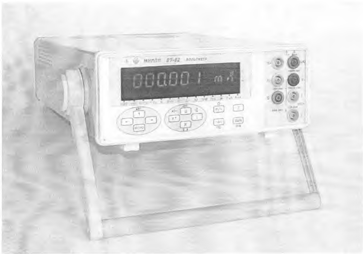
Рисунок 1 – Внешний вид вольтметров В7-82
