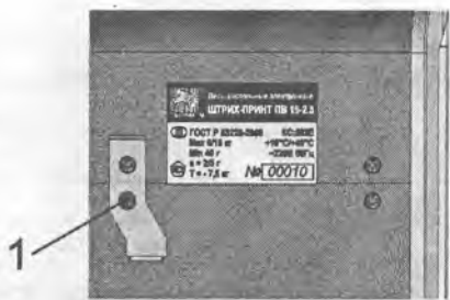
Рисунок 2 - Схема пломбирования весов электронных ШТРИХ-ПРИНТ ПВ (вид снизу)
