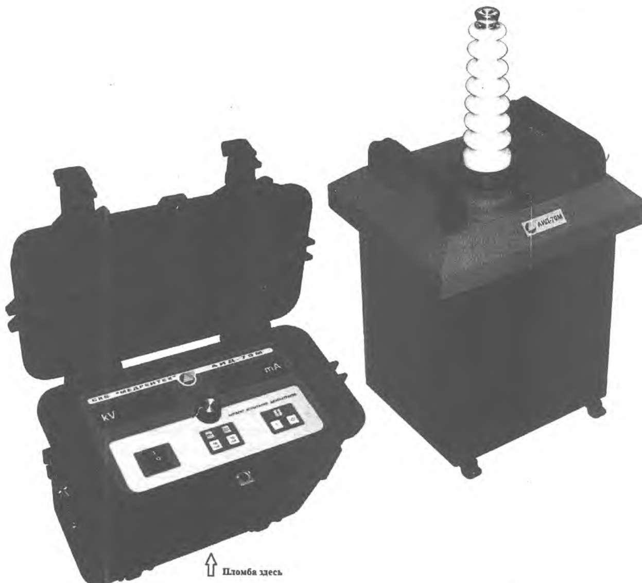
Общий вид аппарата испытания диэлектриков «АИД-70М»
