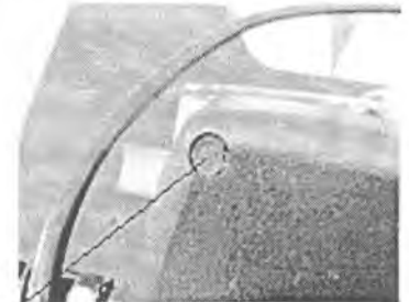
Пломба на крепежный винт корпуса ПЛОТ-3Б-1П (вид сзади) Рисунок 2в
