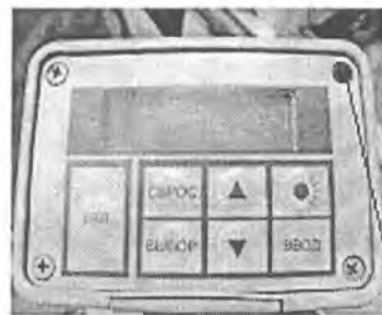
Пломба на крепежный винт корпуса ПЛОТ-3Б-1Р Рисунок 2б
