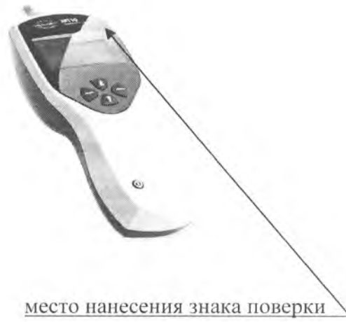
Рисунок 3 - Место нанесения знака поверки на аудиометр импедансный МТ10
