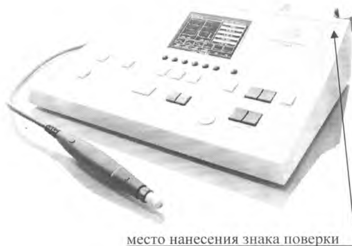
Рисунок 1 - Место нанесения знака поверки на аудиометр импедансный АТ 235
