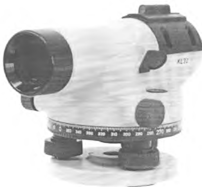
Рисунок 1 - Внешний вид нивелиров
