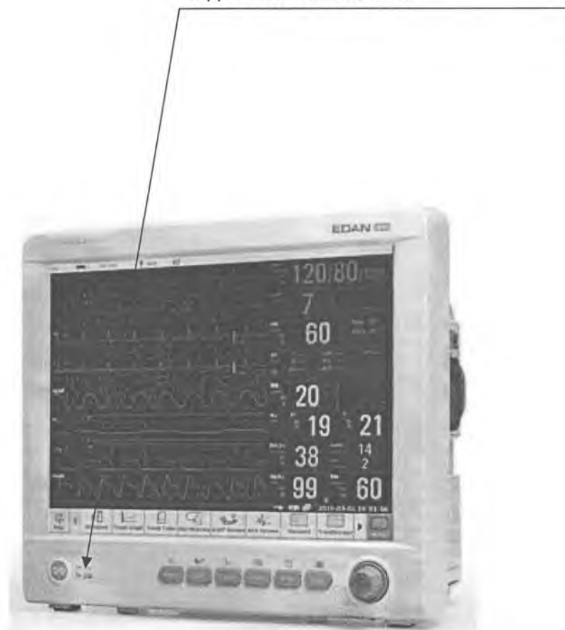
Рисунок А.1– Место нанесения знака поверки в виде клейма-наклейки на мониторы пациента серии М
