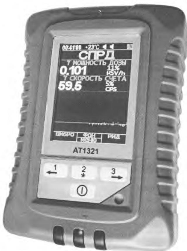
Рисунок 1 – Общий вид спектрометра МКГ-АТ1321
