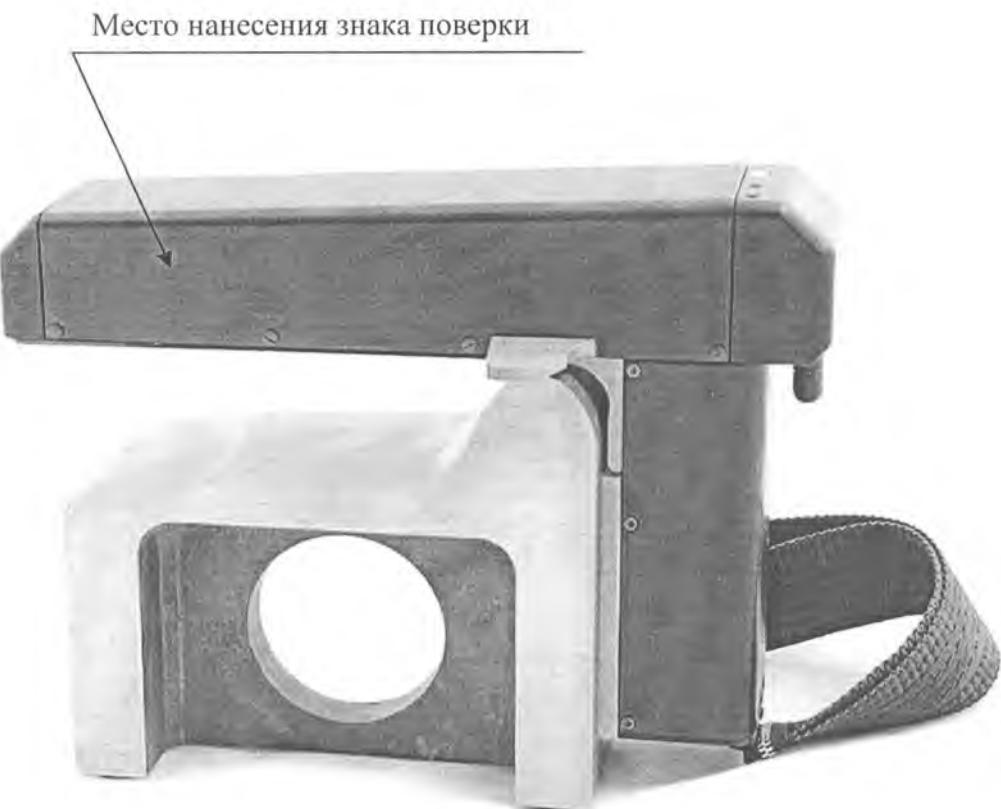
Рисунок А.1 - Внешний вид профилометра поверхности катания колесной пары ИКП и место нанесения знака поверки в виде клейма-наклейки
