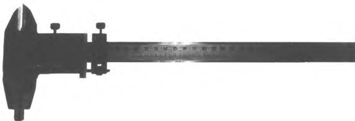
Рисунок 1 – Внешний вид штангенциркуля типа ШЦ-П
