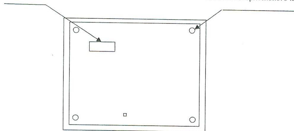
Рисунок 2 - Задняя панель осциллографа С1-157/3.
