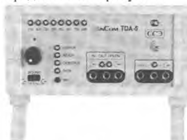
Анализатор со встроенным модемом (программно-аппаратный измерительный комплекс ПАИК / ПАИК-КПВ)
