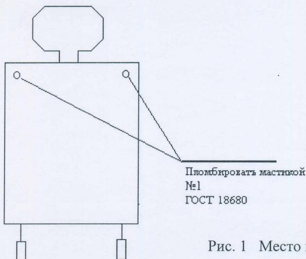
Рис. 1 Место клеймения при поверке
