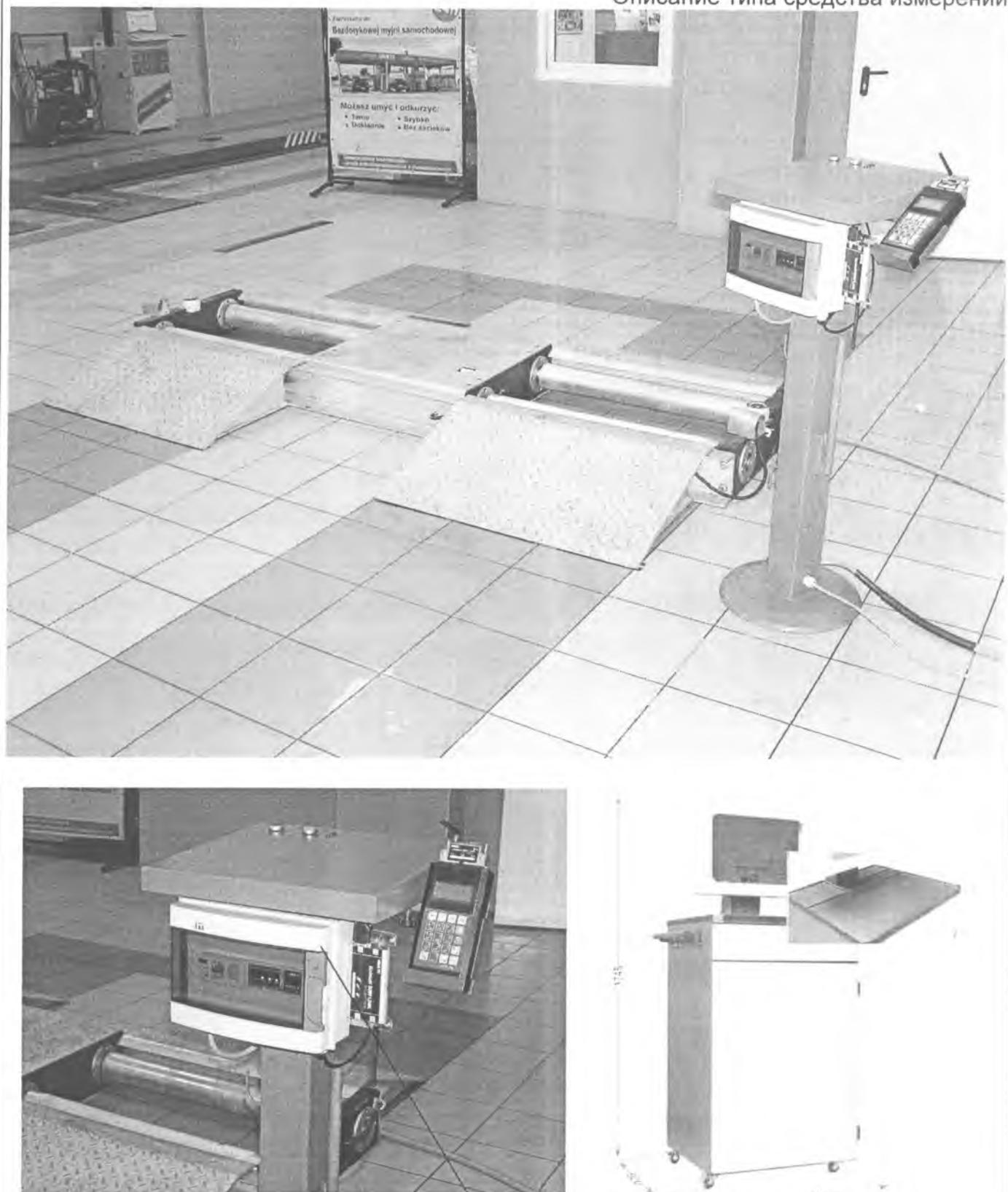
Рисунок 1. Внешний вид стендов для поверки спидометров, одометров, тахографов, таксометров ROLMATT 50 BY, место нанесения знака поверки в виде клейма-наклейки.
