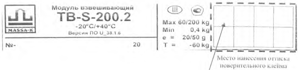
Рисунок 5 – Маркировка модуля взвешивающего и место нанесения оттиска поверительного клейма
