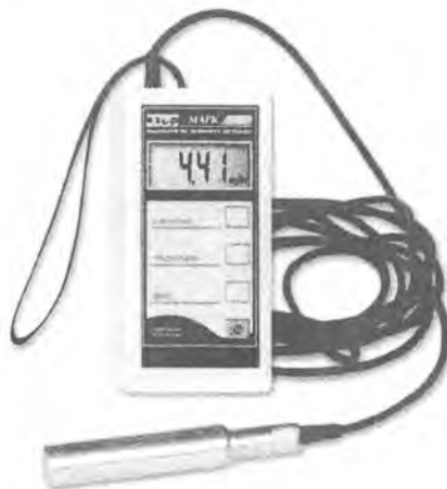
Рисунок – Анализатор растворенного кислорода МАРК-302
