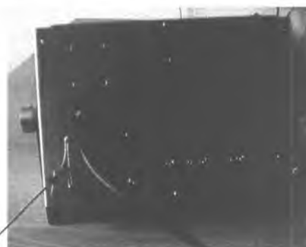
Рис.3 Внешний вид и схема пломбирования индикатора ЭТА-01
