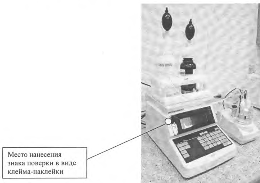
Рисунок 1. Внешний вид титраторов кулонометрических автоматических МКС-520, место нанесения знака поверки в виде клейма-наклейки.
