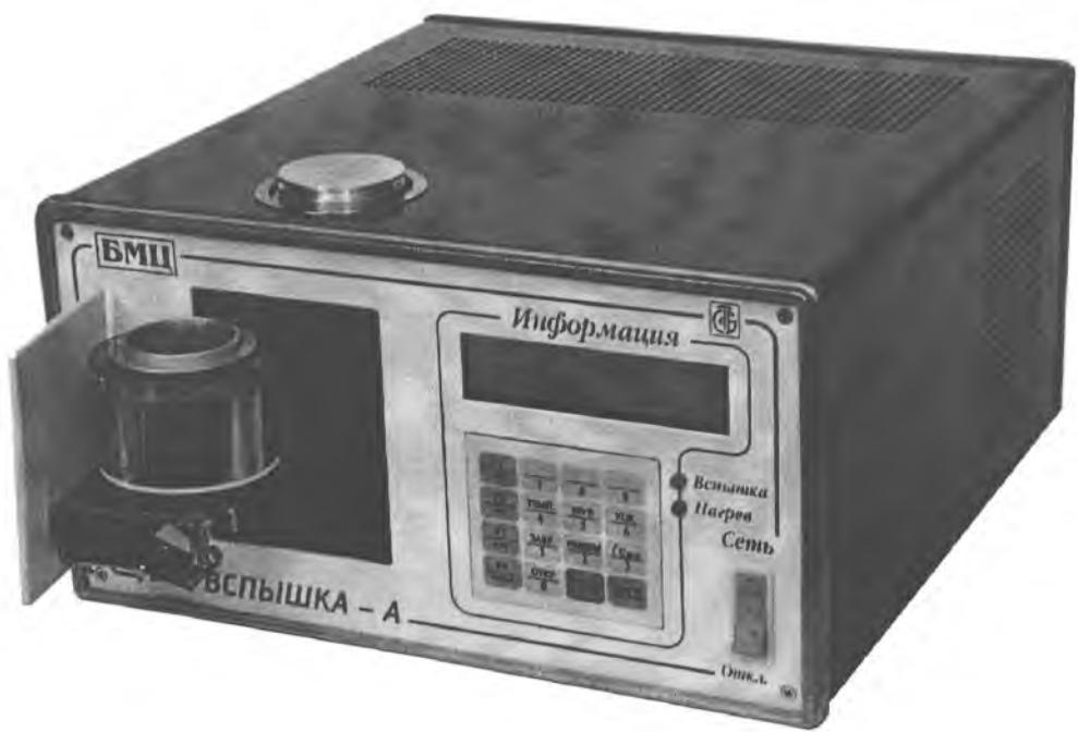
Рис. 1 Внешний вид регистратора автоматической температуры вспышки нефтепродуктов «Вспышка-А»
