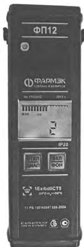
Рисунок 1 Внешний вид течеискателя-сигнализатора ФП 12.
