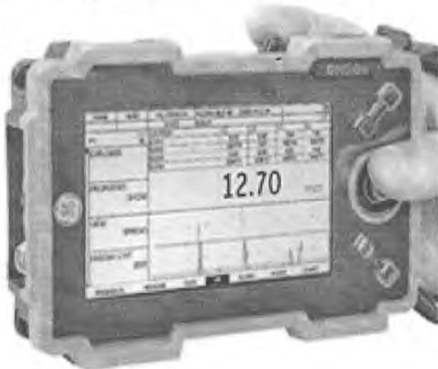
Рис. 1 Внешний вид толщиномеров
