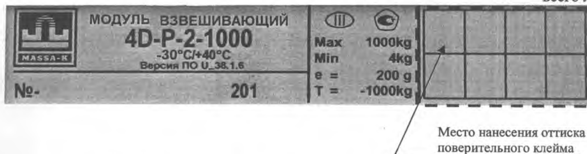
Рисунок 4 – Маркировка модуля взвешивающего и место нанесения оттиска поверительного клейма
