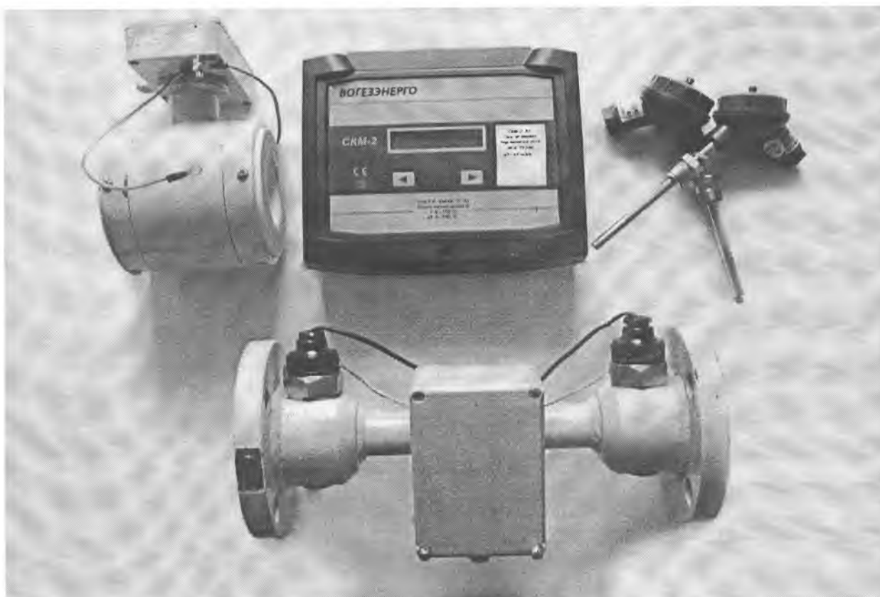
Рисунок 1 – Внешний вид счетчика СКМ-2
