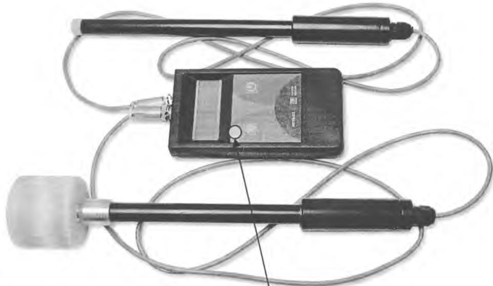
Место нанесения знака поверки в виде клейма-наклейки
