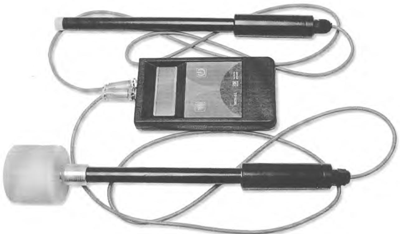
Рисунок 1 – Внешний вид магнитометров промышленной частоты МПЧ-01
